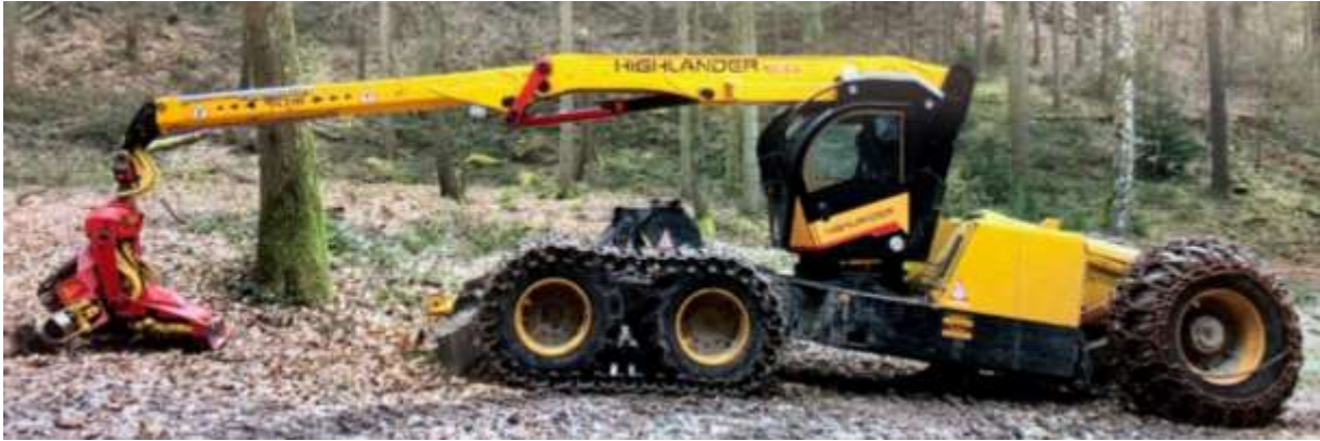
Abbildung 2: Harvester mit Boogiebändern auf der Vorderachse und Ketten auf der Hinterachse zur Steigerung der Traktion und zur Verringerung des Bodendrucks
