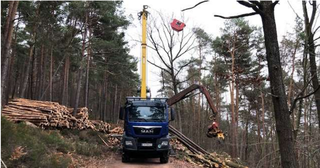
Abbildung 2: Seilkran mit Mast, Seilen, Laufwagen (rot) und Arm mit Prozessorkopf
